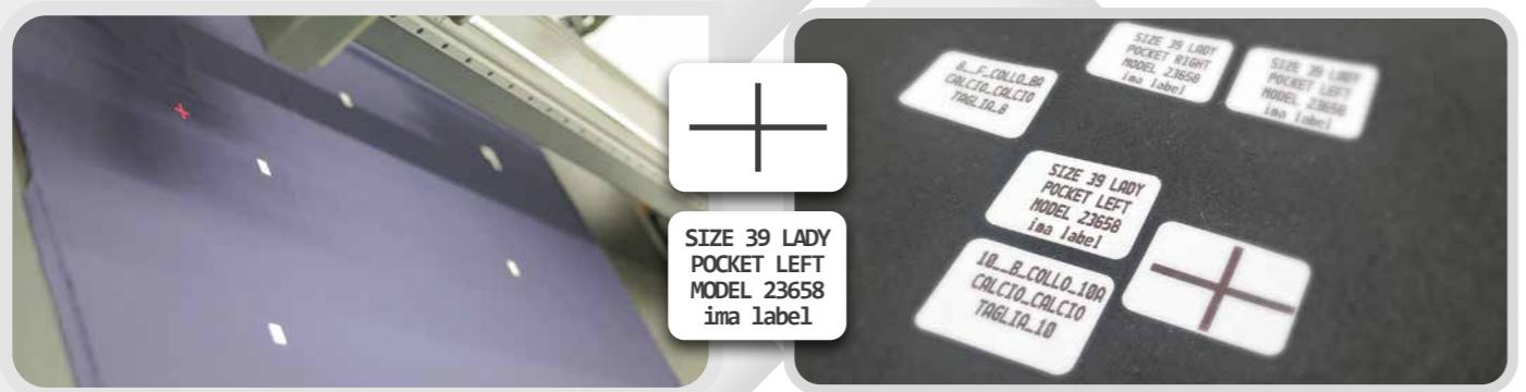
Il software in dotazione è in grado di correggere automaticamente la posizione delle etichette, applicandole esattamente al centro delle sagome o consentendo all'operatore di muoverle a propria discrezione. E' possibile aggiungere, rimuovere, duplicare e modificare ogni etichetta.
