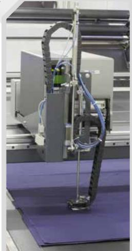
Il sistema applica automaticamente le etichette adesive sull'alto del materasso, riportando le informazioni necessarie al riconoscimento delle parti del modello e del lotto.
